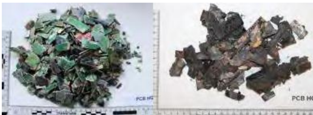
Rys. 2. Widok próbki złomu PCB typu HIGH GRADE przed procesem pirolizy (lewa strona) oraz otrzymanego karbonizatu po procesie (prawa strona).
