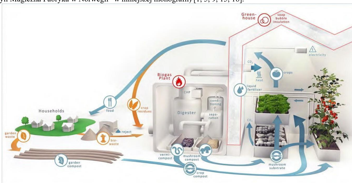
Rys. 14. Schemat działania aktywnej cieplarni BBBLs z biogazownią (Fot. Food to Waste to Food (F2W2F)).
