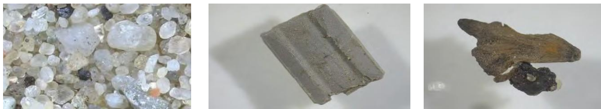
Rys. 7. Analiza wizualna piasku (P_3) z wykorzystaniem mikroskopu cyfrowego
