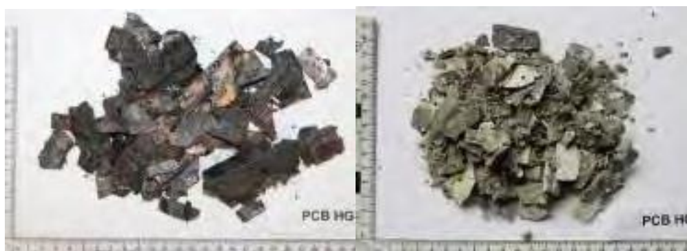
Rys. 3. Widok próbki materiału PCB HIGH GRADE przed (lewa strona) oraz po (prawa strona) procesie prażenia.
