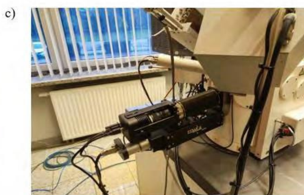
Rys. 7. a) Stanowisko pomiarowe skaningowej mikroskopii elektronicznej (SEM) [6], b) stolik do montażu próbek, c) obiektyw służący do podglądu wnętrza mikroskopu
