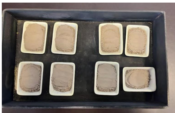
Rys. 2. Próbkę stali pokryte popiołem przed umieszczeniem w piecu muflowym.
