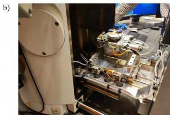
Rys. 7. a) Stanowisko pomiarowe skaningowej mikroskopii elektronicznej (SEM) [6], b) stolik do montażu próbek, c) obiektyw służący do podglądu wnętrza mikroskopu
