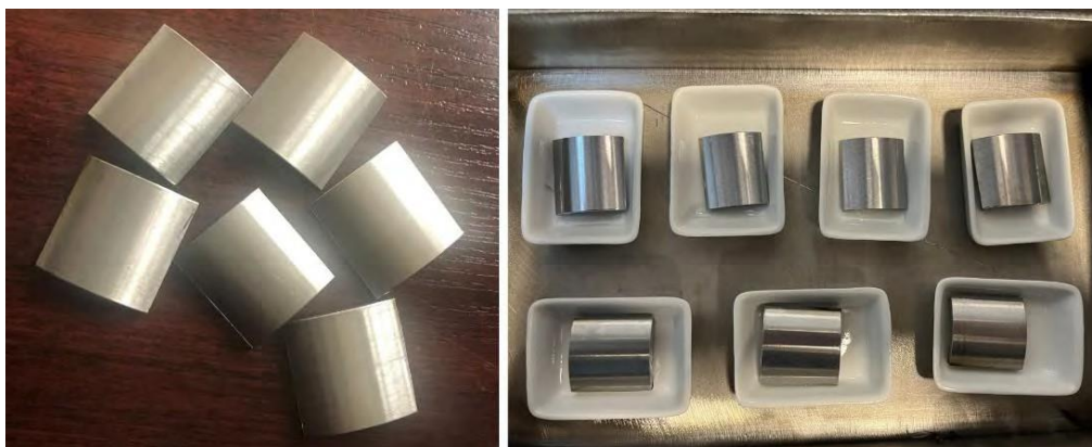
Rys. 1. Próbkę stali przygotowane do przeprowadzenia badań korozyjnych.
