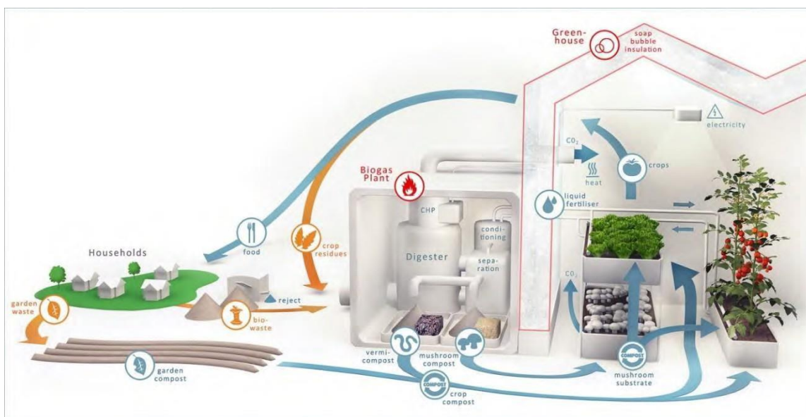
Rys. 8. Schemat działania aktywnej ciepłarni BBBS z biogazownią (Fot. Food to Waste to Food (F2W2F)).
