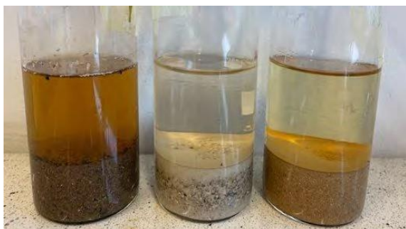
Rys. 12. Analiza wizualna zawartości substancji organicznych w badanych piaskach, a) P_1, b) P_2, c) P_3, d) P_4, e) P_5, f) P_6, g) P_7
