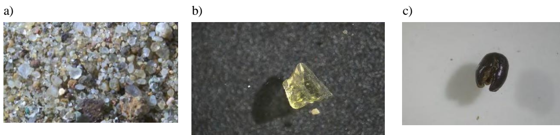
Rys. 8. Analiza wizualna piasku (P_4) z wykorzystaniem mikroskopu cyfrowego
