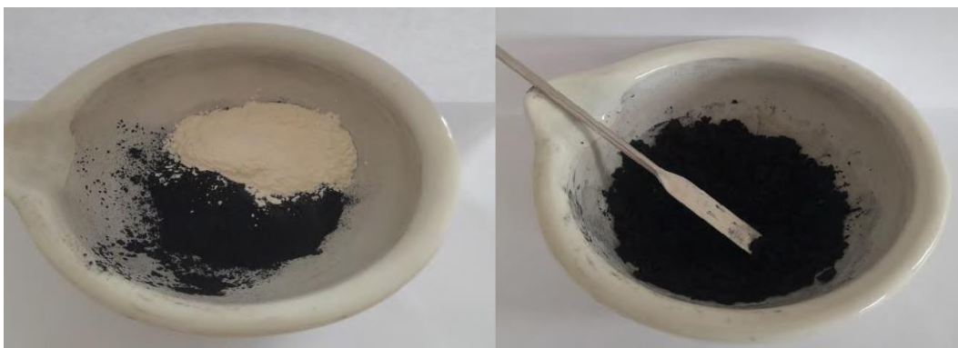
Rys. 5. Mieszanka węgla i polimeru PVF przed i po wymieszaniu z rozpuszczalnikiem DMF [Zdjęcie własne].
