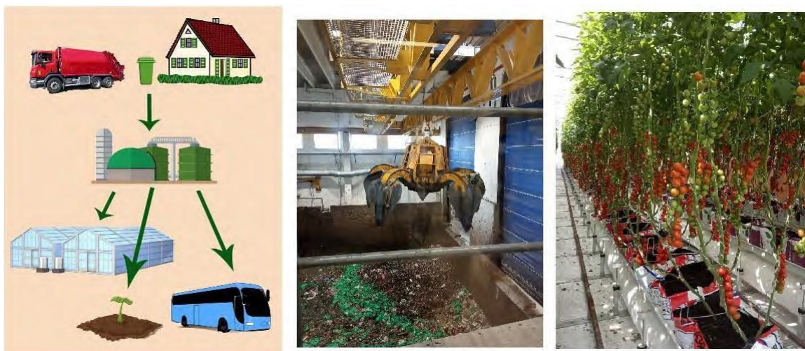
Rys. 4. Przetwarzanie odpadów w biogazowni Magicznej Fabryki w biogaz (paliwo), bionawóz i „zielony” CO 2 do produkcji warzyw w cieplarni BBLS (Fot. L. Dawidowicz, Thinglink [18]).
